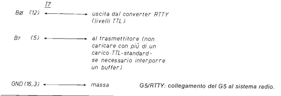
Essendo alcune linee poste in comune, può essere montato un deviatore per scegliere il registratore o l'uso RTTY. Il programma viene lanciato, per la ricezione in Baudot, con una semplice chiamata al suo indirizzo iniziale; ad esempio facendo
